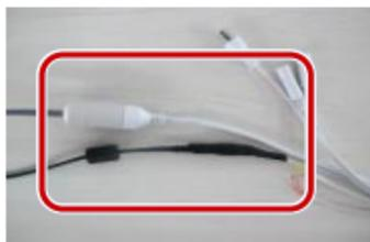
3 Обмотайте остальные кабели изоляционной лентой.
