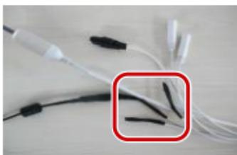
4 Обмотайте все ответвительные кабели изоляционной лентой.
