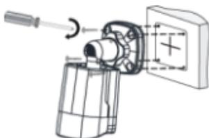
Вставьте саморезы в направляющие отверстия, расположенные в основании, и закрутите их в стену отверткой.
