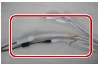
2 Обмотайте соединённые кабели изоляционной лентой.
